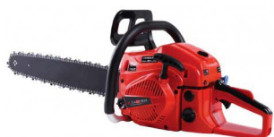
Benzininis pjūklas K-Samurai KJ5400Z Galia: 2,2 kW. Cilindro darbinis tūris: 54,0 cm³. Grandinės žingsnis: 0,325". Pjovimo juostos ilgis: 16" (40 cm).
